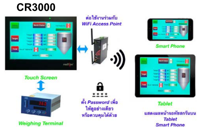
รูปที่ 13 ต่อ Touch Screen ร่วมกับ WiFi Access Point เพื่อแสดงค่าหรือควบคุมบน Smart Phone หรือ Tablet
